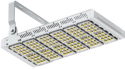
Projecteur tunnel à led grand angle de 140 x 75°. Puissance 300W, flux lumineux de 33000 Lumens.
